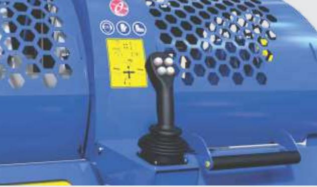
**Joystick-ul** asigura o operare simpla, rapida fara efort fizic. Operatiunile de pornire a masinii, avans, tajere si despicare a busteanului cat si reglajul cutitului sunt comandate cu ajutorul Joystick-ului.
