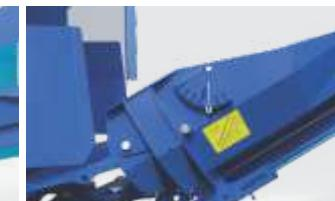
**Inclinometru** pozitionat pe banda de evacuare ajuta la pozitionarea optima a benzii.
